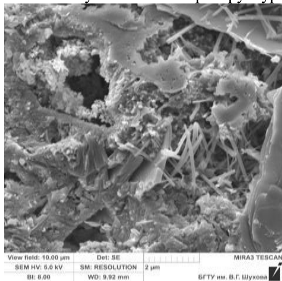
Рисунок 3.9 – Микроструктура цементного камня из вяжущей композиции состава 1-4 в возрасте 7 суток
