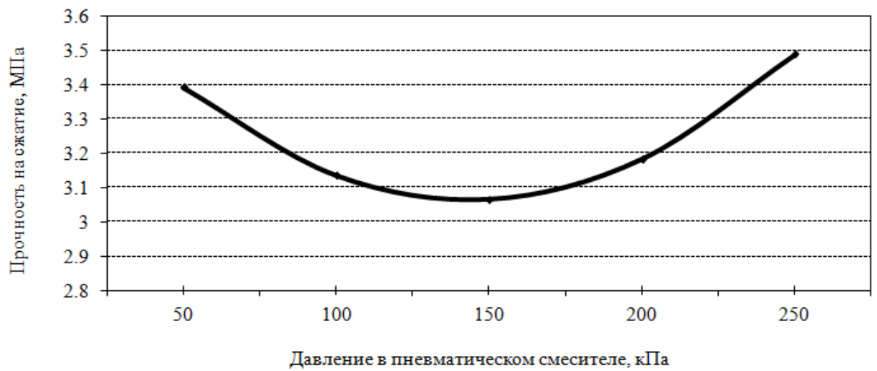
Рисунок 5.15 – Зависимость прочности теплоизоляционного раствора от давления в пневматическом смесителе
