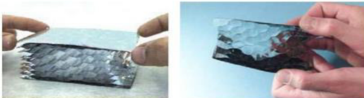
Рисунок 1.10 – Барьерная фольга и перегородка внутри ГНП
