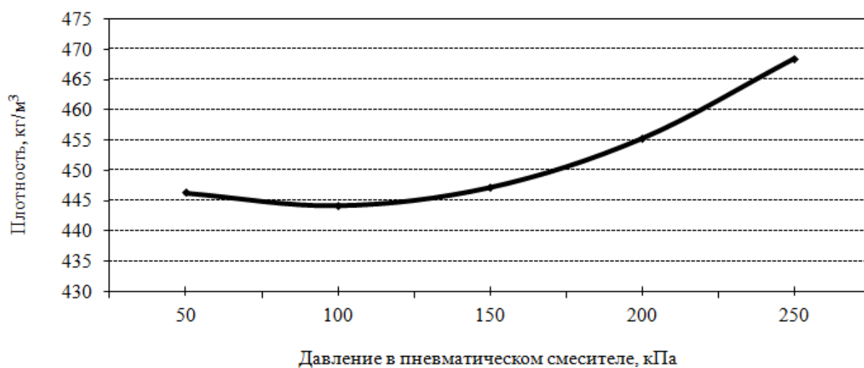
Рисунок 5.9 – Зависимость плотности теплоизоляционного раствора от давления в пневматическом смесителе
