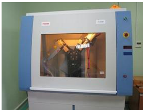
Рисунок 2.4 – Аппарат для проведения рентгенофазового анализа ARL X'TRA Thermo Fisher Scientific
