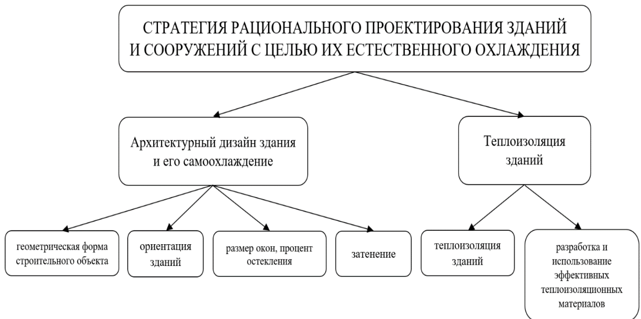
Рисунок 1.6 – Стратегия рационального проектирования зданий и сооружений
