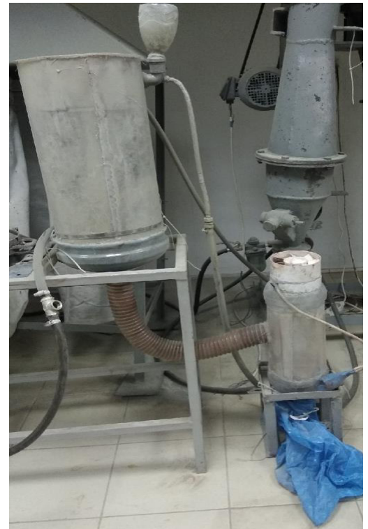
Рисунок 5.2 – Лабораторная установка пневматического со спиральной энергонесущей трубкой
